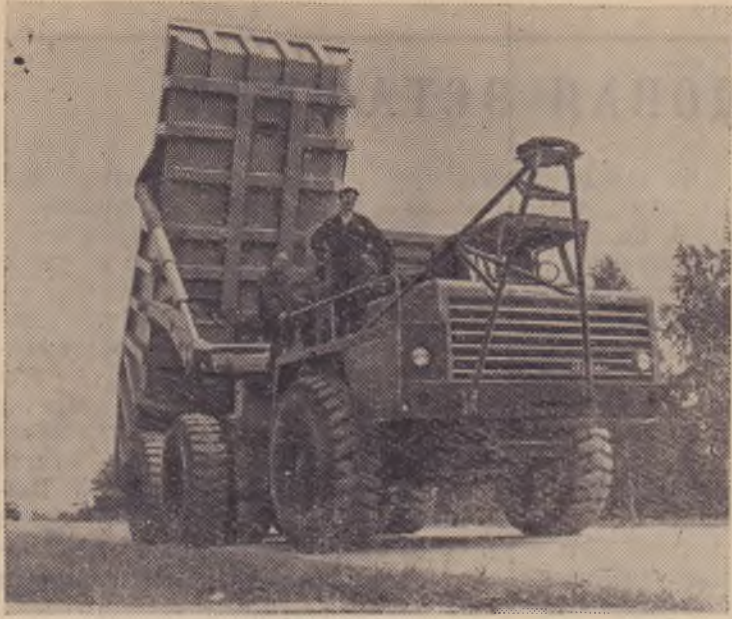
На белорусском автомобильном заводе изготовлен опытный образец автопоезда-троллейвоза „Белаз-Э 524“. Его грузоподъемность 65 тонн, скорость 50 километров в час. Машина имеет четыре электромотора-колеса, которые получают электроэнергию со стороны через троллейное устройство, а также и от своего генератора, приводимого во вращение дизельным двигателем. Мощность одного электромотора-колеса—200 киловатт. Автопоезда-троллейвозы найдут широкое применение в угольной и горнорудной промышленности. Сейчас опытный образец проходит заводские испытания. НА СНИМКЕ: автопоезд-троллейвоз „Белаз-Э 524“. Фото Г. Усламова. Фотохроника ТАСС
